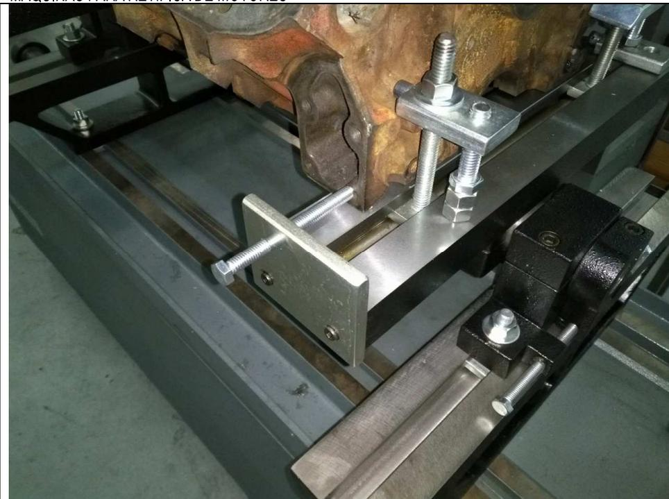
O bloco deve ficar apoiado nos parafusos de ajuste vertical tanto faz se os parafusos ficarem para fora ou para dentro, daí é questão de como ficar melhor para fixar o bloco, nesse caso um bloco GM optei por fixação com grampos nas extremidades
